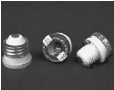
▲ FIGURA 4.20 Fusibles a) Un fusible contiene una tira o una cinta metálica que se funde cuando la corriente excede cierto valor establecido. Esto abre el circuito y evita el sobrecalentamiento. b) Los fusibles base de Edison (a la izquierda) tienen una rosca similar a la de las bombillas de luz. Las roscas son idénticas en este tipo de fusibles; así, es posible intercambiar fusibles con diferente clasificación de amperaje. Los fusibles tipo S (a la derecha) tienen roscas distintas para clasificaciones diferentes, por lo que no es posible intercambiarlos.
