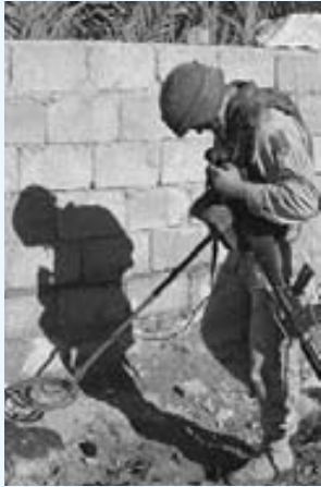
FIGURA 1 Un detector de metales de dos bobinas En esta fotografía se distinguen las dos bobinas: la transmisora (exterior, de mayor tamaño) y la receptora (interna y más pequeña).
