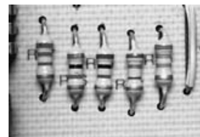
▲ FIGURA 3.9 Resistores en uso Un tablero de circuito impreso, típicamente usado en computadoras, incluye resistores de diferentes valores. Los grandes cilindros rayados son resistores; sus códigos de bandas de cuatro colores indican sus resistencias en ohms.
