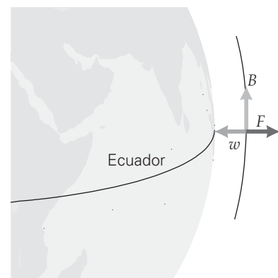
▲ FIGURA 5.15 ¿Desafío de la gravedad con un campo magnético? Cerca del ecuador terrestre existe la posibilidad teórica de anular el tirón de la gravedad con una fuerza magnética hacia arriba sobre un conductor. ¿Cuál debe ser la dirección y la magnitud de la corriente? (Véase el Ejemplo integrado 5.4.)
